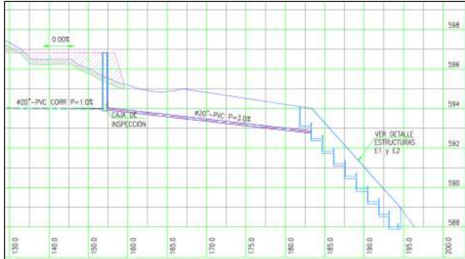
Figura 7-10. Perfil longitudinal estructuras proyectadas en la margen izquierda de la Quebrada NN (Afluente Sin Nombre 5) ocupaciones Desc_OC_1 y Desc_OC_2
