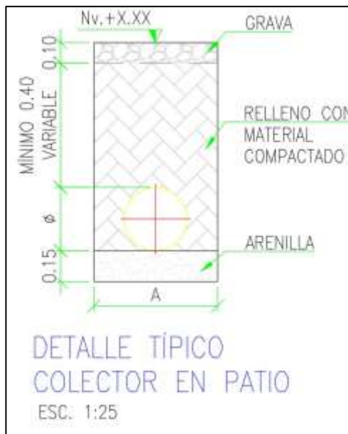
Figura 7-6. Detalle colector C3 y C5 asociado al tramo de ocupación de cauce Desc_OC_1 y Desc_OC_2
