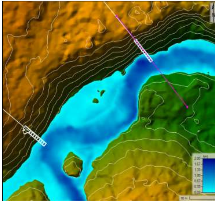
Figura 5-71. Detalle mancha de inundación para el escenario de T_r = 100 años. Descarga 2.
