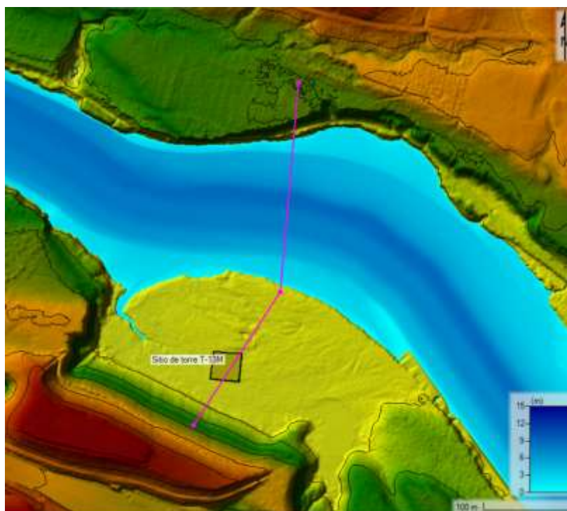
Figura 5-62. Mancha de inundación sobre la fuente de interés escenario QTr 15 años (Torre T-13M).
