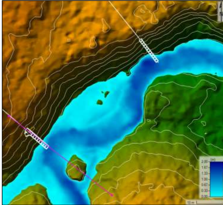
Figura 5-69. Detalle mancha de inundación para el escenario de T_r = 100 años. Descarga 1.
