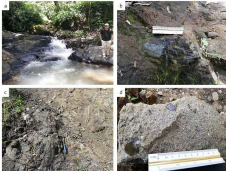
Figura 5-2. Afloramientos de rocas de la Formación Combia: a) Tobas; b) madera carbonizada en tobas; c) secuencia de basaltos y tobas; d) toba de lapilli litocristalina.
