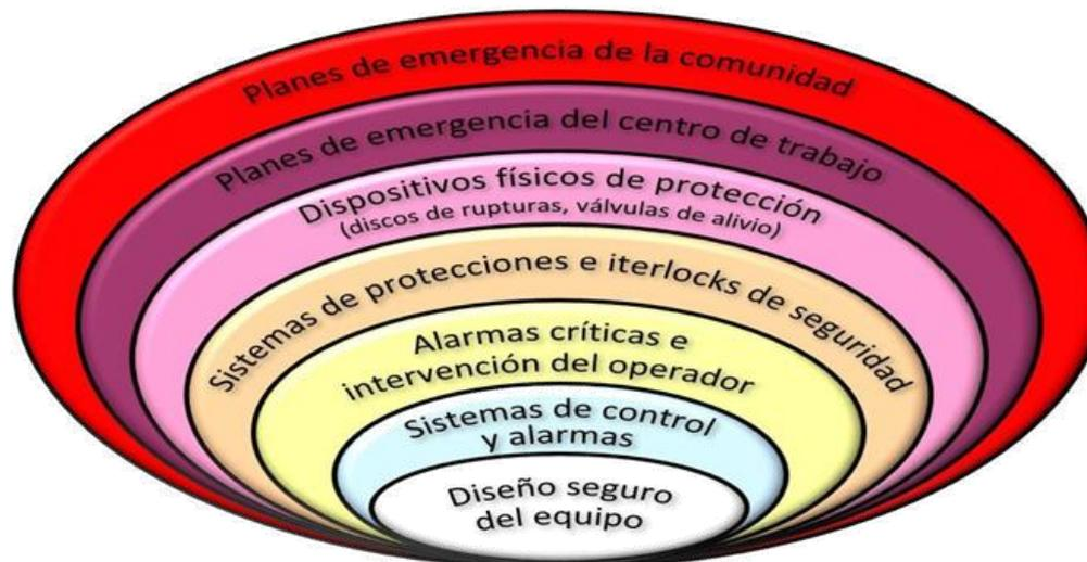
Figura n°2. Análisis por capas de protección (LOPA)
